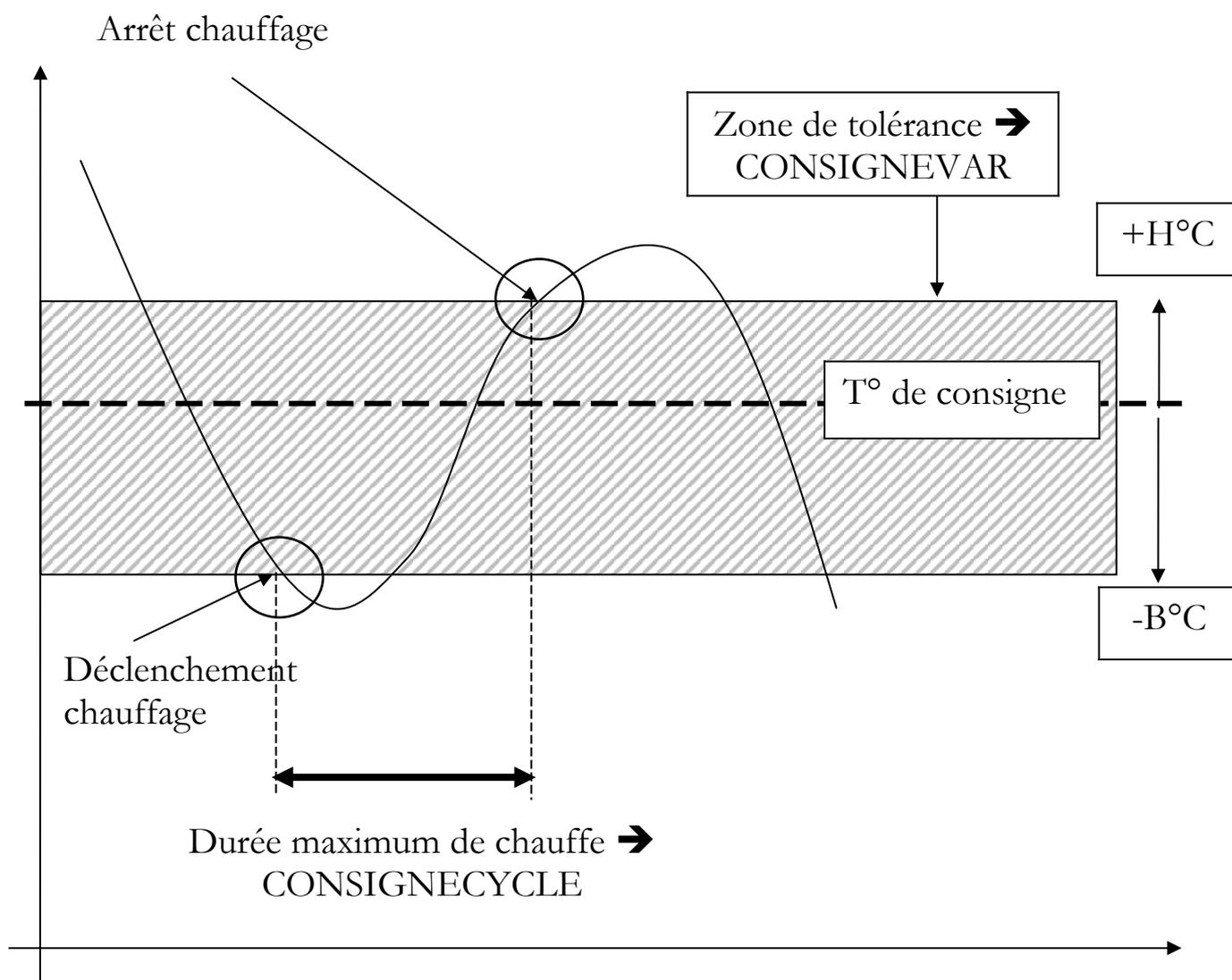
La durée maximale de chauffe est réglée par le paramètre CONSIGNECYCLE. Elle se mesure par défaut en tranche de 3 minutes (qui correspondent à l'intervalle de temps entre chaque relevé de température) → voir page suivante / voir réglages avancés.
