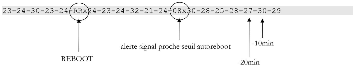
Le dernier chiffre correspond à la mesure la plus récente. Lorsqu'un chiffre est proche sur seuil minimum défini par **AUTOBOOT+GSM+N**, un « x » est affiché à la place du tiret (8% dans l'exemple ci-dessus). La mention **RRx** indique un redémarrage de la DOMEEOBOX.
