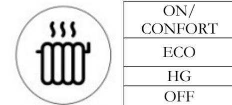
*Votre DOMEEBOX peut contrôler jusqu'à 12 modules « fil pilote » 4 ordres (ARRET, HORS-GEL, ECO et CONFORT).*
